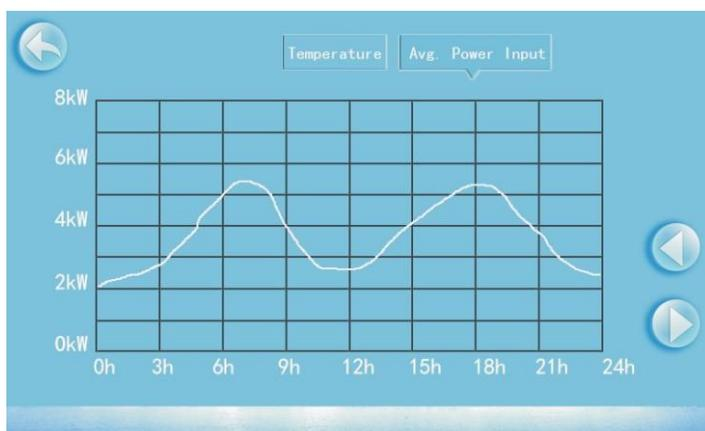
La curva de la temperatura se actualiza automáticamente cada hora y el registro de la curva se puede guardar durante 60 días;
