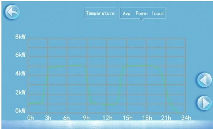
La curva de temperatura se actualiza automáticamente cada hora y el registro de la curva se puede almacenar durante 60 días.
